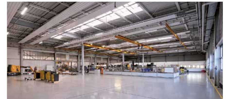
Innenraum der neuen Trocknerfertigung. Die ehemals gelbe Außenfassade vom Bestand ist zur neuen Innenwand des Anbaus geworden.
