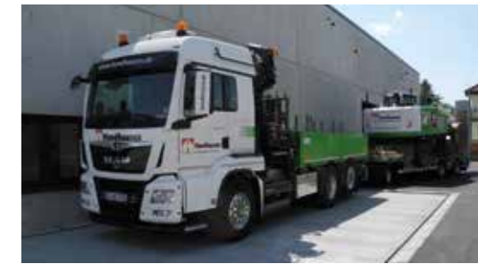
▲ MAN TGS 26.500 Lkw mit hydrostatischem Antrieb auf der Vorderachse incl. Tieflader, der über Radmulden verfügt, der hohe Mobilbagger und Radlader transportieren kann.
