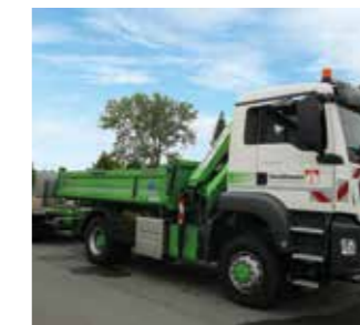
▲ Allrad-Kipper MAN TGS 18.460 mit Palfinger Ladekran
