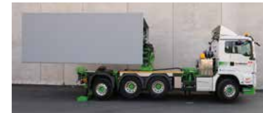
▲ Garagen-Transportfahrzeug MAN TGS 35.500 mit Garagen-Versetzaufbau, System Deuringer Typ 142/7K, für Garagen bis 7 m Länge
