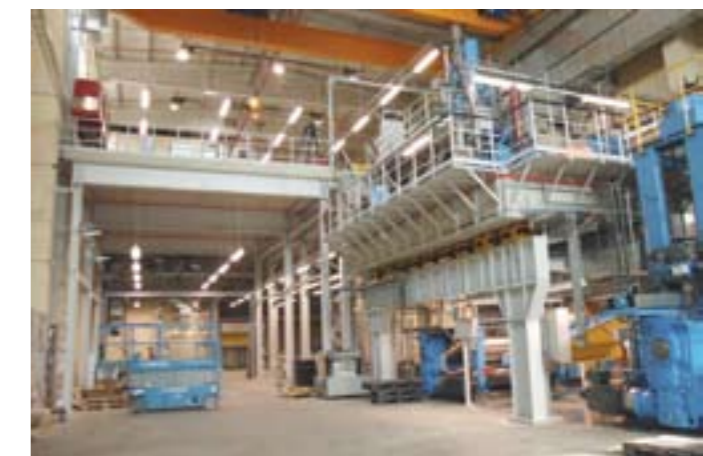
◀ Links: Zwischendecke zur Belieferung der Mischerlinie 7; rechts: fertig gestellter Mischertisch
